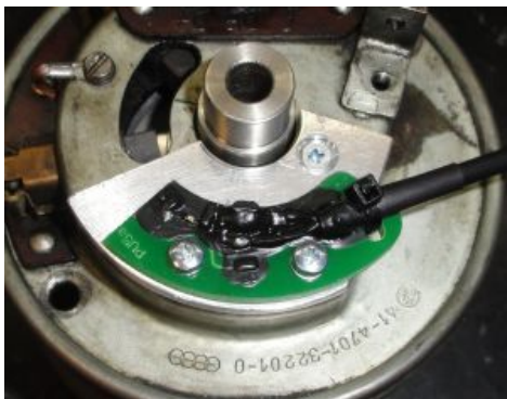
Die Sensorplatte mit den beiden M3-Schrauben montieren.
