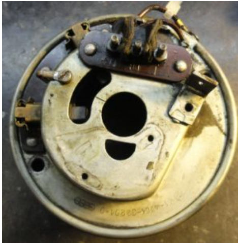
Den Fliehkraftregler und die Kontaktplatte komplett entfernen, auch den Filz.
