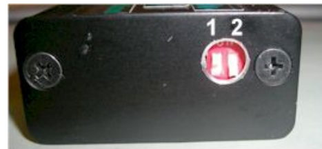
Abbildung 4 DIP-Schalter und Zündkurvenauswahl.
